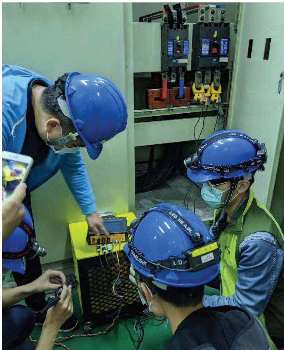
圖 120 電機系學生量測電力品質
