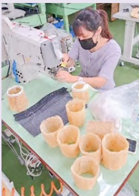
▲ 圖 7-123 112 年研發及生產 絲瓜絡隔熱杯套
