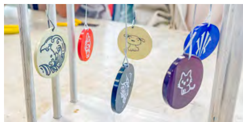
▲ 圖 7-114 113 年使用電泳及雷射雕刻加工方式製作文創商品
